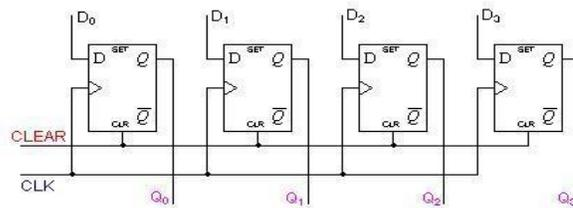
**Fig. 8. PIPO Block Diagram**
