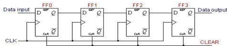
**Fig. 6. SISO Block Diagram**
